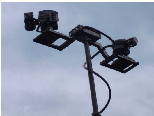
CCTV-System mit Wärmebildkamera VarioCAM® hr head 620
